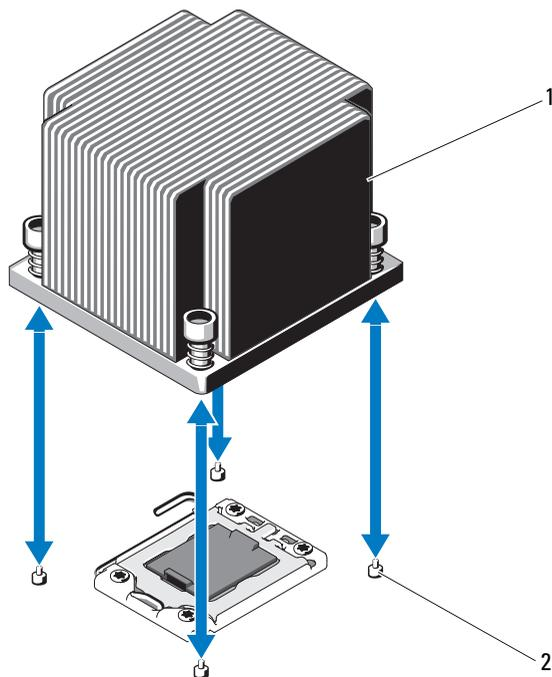
1 Kühlkörper    2 Befestigungsschrauben (4)
